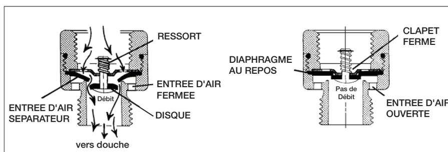
Le dispositif antipollution HD 206, possède une double protection contre le siphonnage et/ou le retour d'eau. Il est composé d'une soupape anti-vide et d'un clapet de non-retour.
